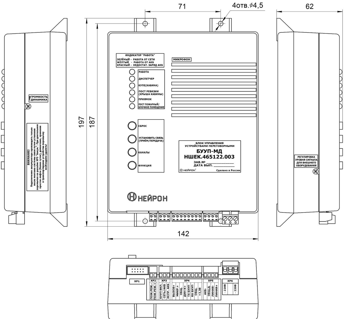
Рис.1 Внешний вид Блока управления устройствами переговорными «БУУП-МД» НШЕК.465122.003
